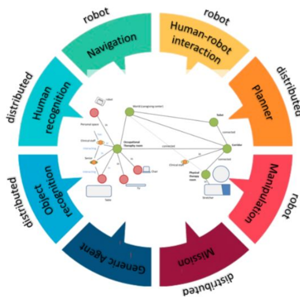
Figura 2. Esquema representativo de la arquitectura CORTEX+. Los agentes, locales en el robot o distribuidos en el ALab leen y modifican el grafo para ejecutar sus acciones
